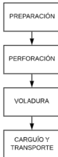
Diagrama de Flujo de los procesos que se realizan en la concesión minera
