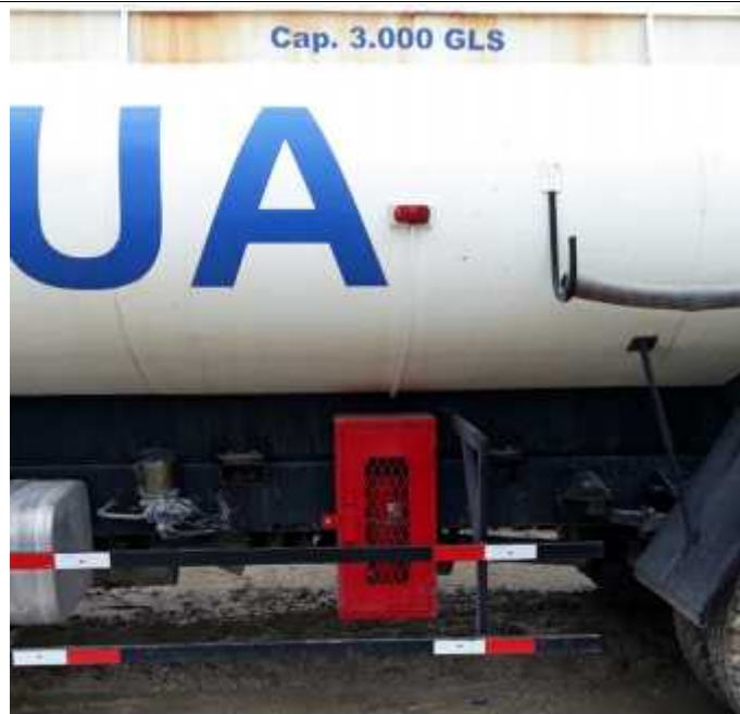
4.- EXTINTOR EN TANQUERO DE AGUA CRUDA
