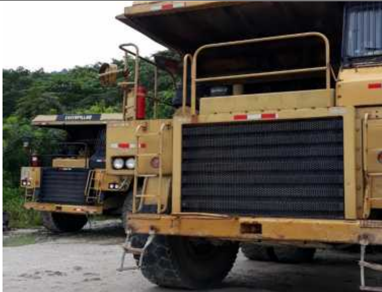
6.- EXTINTOR EN EQUIPO DE ACARREO DE CANTERA
